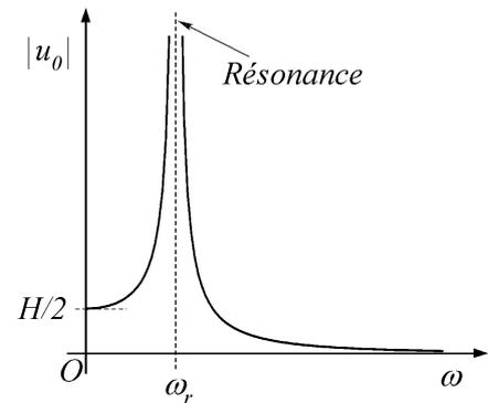
La pulsation de résonance vaut  $\omega_r = \sqrt{\frac{k}{m}}$ . Le régime de confort maximal correspond aux grandes pulsations, i.e.  $\omega \rightarrow \infty$ , et donc aux vitesses, i.e.  $v \rightarrow \infty$ .
