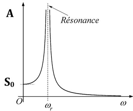
La condition de résonance correspond à la divergence de l'amplitude  $A = u_0$  des oscillations. Ainsi, la pulsation de résonance vaut  $\omega_r = \sqrt{\frac{k}{m}}$ .
